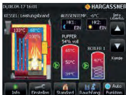
Panna vid fullast: Displayen visar en Arbetande panna. VVB och Ackumulator laddas. Värmekretsar säkerställer önskad temperatur på varje värmekrets.
