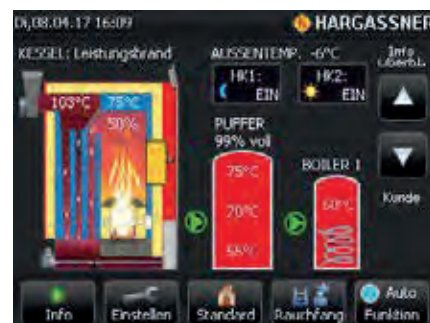
Panna vid delast: Displayen visar en panna på halv effekt. Pannan och ackumulatören är redan laddade. Värmekretsar säkerställer önskad temperatur i varje värmekrets.
